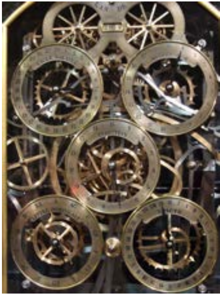
Computusteil der Astronomischen Uhr im Straßburger Münster: zur Jahreszahl 2014 werden u.a. Epakte, Goldene Zahl und Sonntagsbuchstabe angezeigt. Foto des Verfassers
